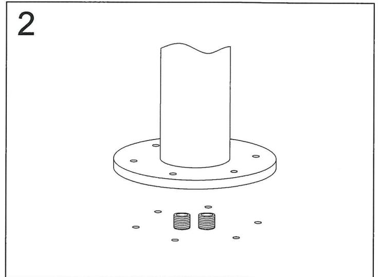
2. Bohren Sie die Befestigungsloecher.
