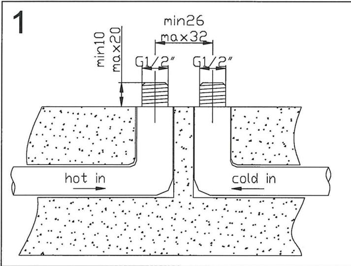
1. Installieren Sie die Zuleitungen wie gezeigt im vorbereiteten Fundament. Warm links, Kalt rechts .
